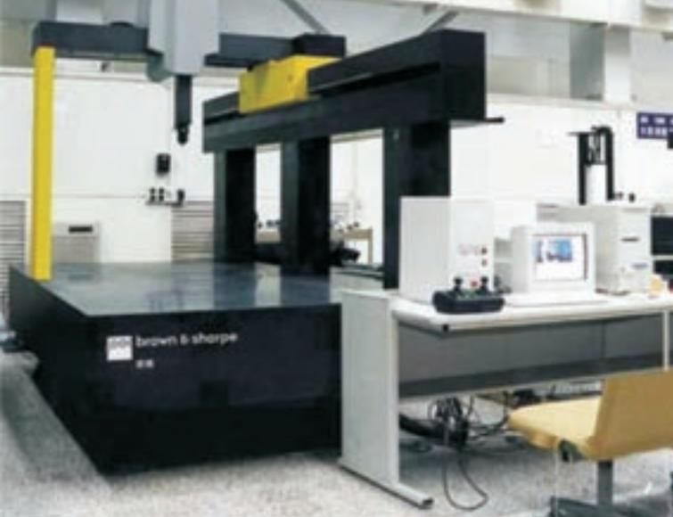
Рис. 2. КИМ с полупорталом фирмы Brown&Sharpe
