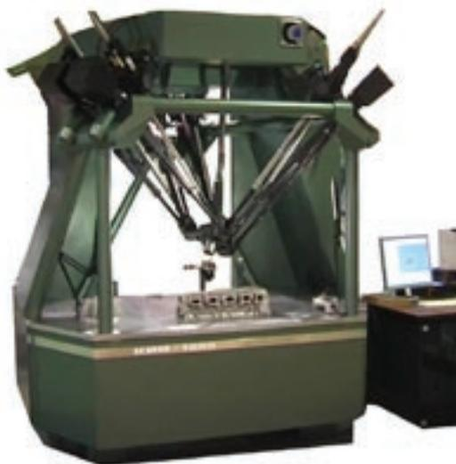
Рис. 8. Многостержневая (гексаподная) КИМ фирмы ЛАПИК
