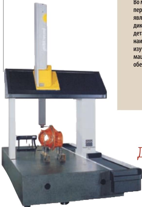
Рис. 1. КИМ портальной компоновки фирмы DEA
