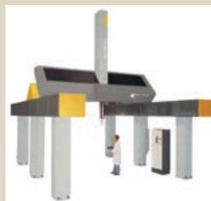
Рис. 4. КИМ мостовой компоновки фирмы Brown&Sharpe
