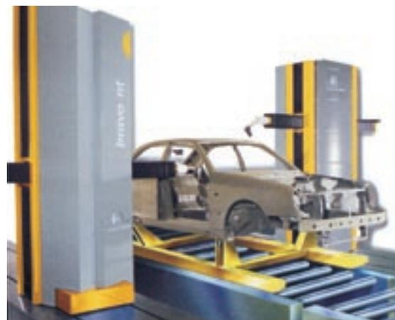
Рис. 5. Двухстоечная КИМ фирмы Brown&Sharpe
