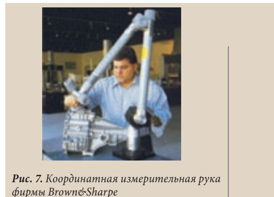
Рис. 7. Координатная измерительная рука фирмы Brown&Sharpe
