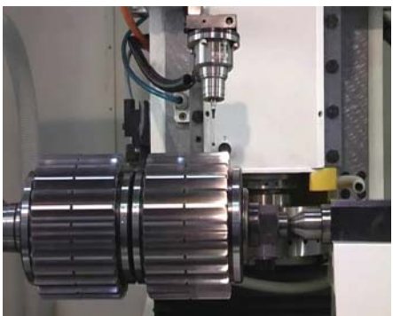
Рис. 9. Система технологического контроля при обработке зубчатого колеса на станке с ЧПУ
