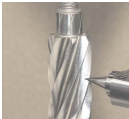
Рис. 6. Измерения на КИМ GearSpect DO-3PC
