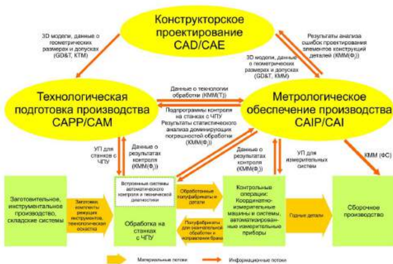
Рис. 3. Схема концепции единого информационного пространства современного машиностроительного производства
